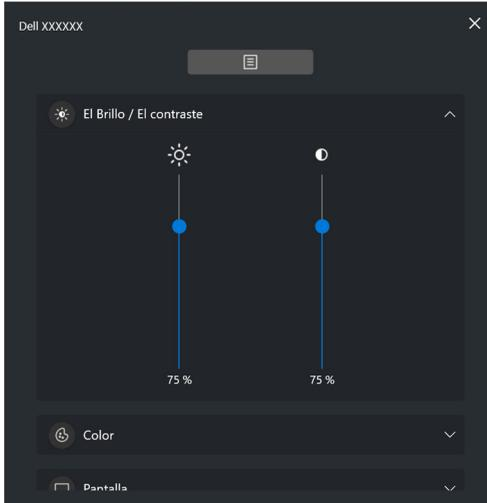
**NOTA:** El valor mínimo del ajuste de contraste se establece en un 25% para mantener la visibilidad en la pantalla.
