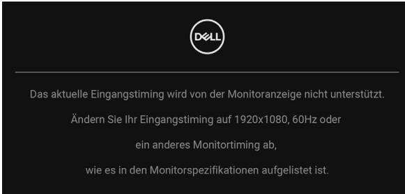
Das bedeutet, dass sich der Monitor nicht richtig auf das Signal einstellen kann, das er vom Computer empfängt. In den [Technische Daten des Monitors](#) finden Sie die von Ihrem Monitor unterstützten Horizontal- und Vertikalfrequenzen. Empfohlener Modus ist 1920 x 1080.
