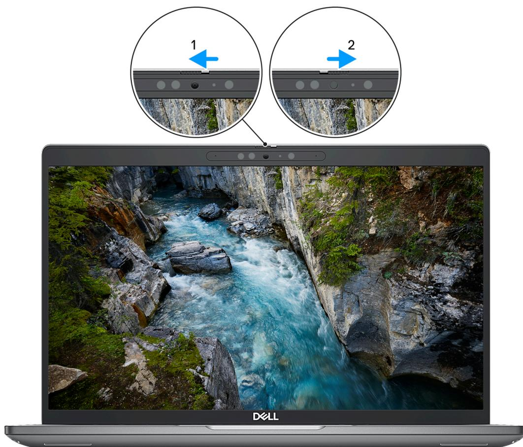
Figura1. Obturador da câmara
