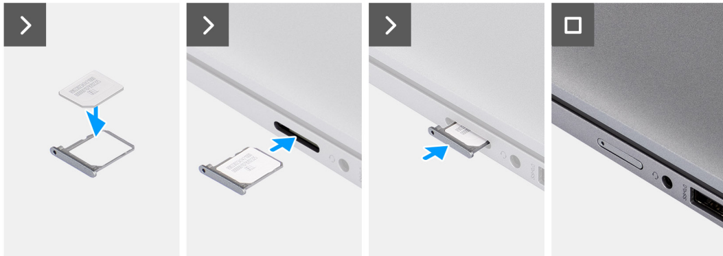
Ilustración 3. Instalación de la bandeja para tarjeta SIM
