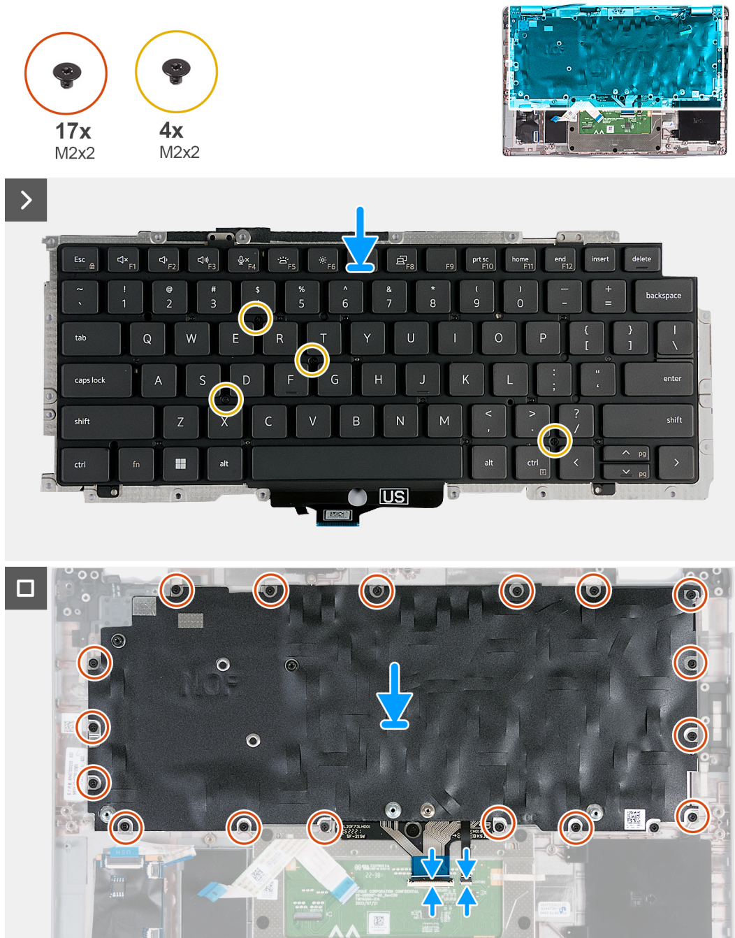
Ilustración 66. Instalación del teclado
