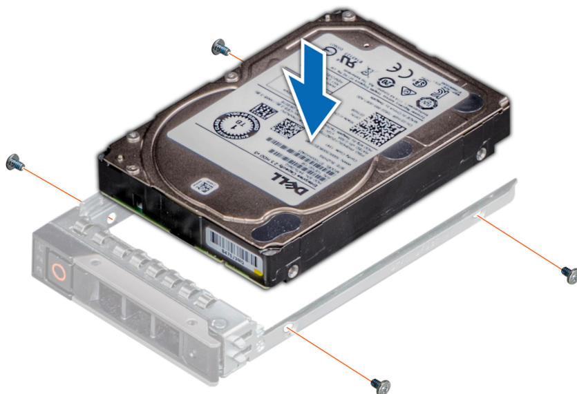
Ilustración 33. Instalación de una unidad en el portaunidades
