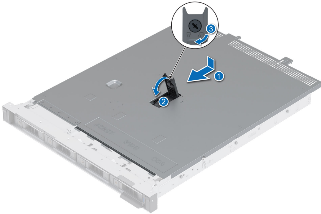
Ilustración 14. Instalación de la cubierta del sistema
