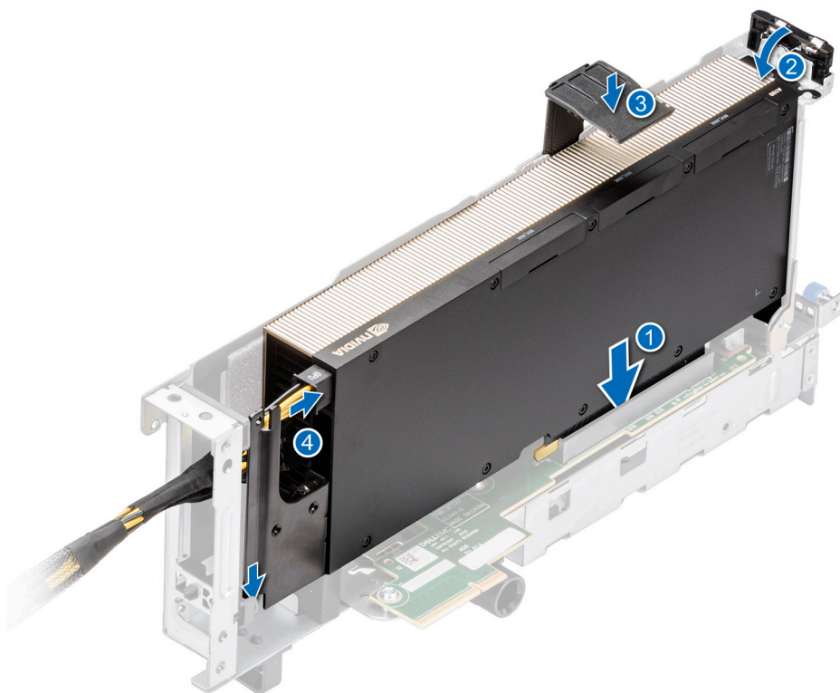
Ilustración 164. Instalación de la GPU en el soporte vertical 1
