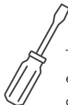
Tournevis plat largeur 4 mm / épaisseur 0,8 mm pour le montage des mécanismes MÉMOIRE.
