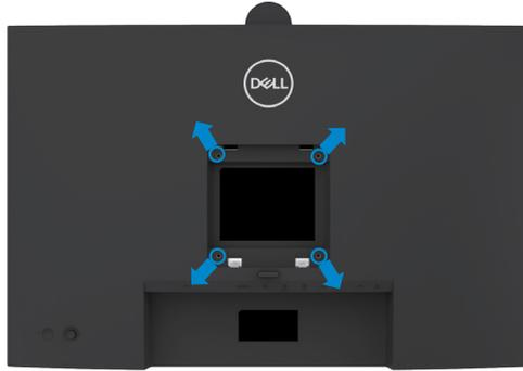
**NOTA:** Utilice tornillos M4 x 10 mm para acoplar el monitor al kit de instalación en pared.
