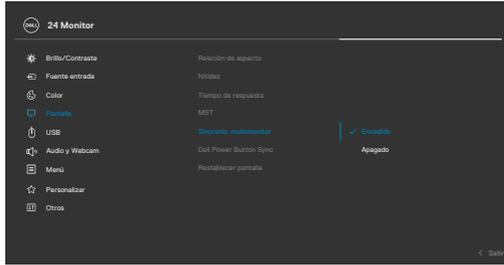
Después de la primera sincronización, la sincronización posterior se lleva a cabo mediante cambios en el grupo predefinido de configuraciones del menú OSD desde cualquier monitor de la cadena. Cualquier monitor puede iniciar los cambios en sentido descendente y ascendente.
