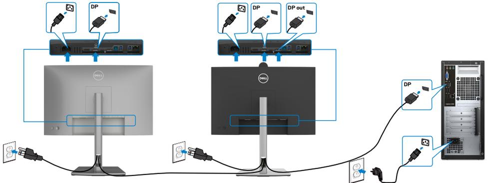
**NOTA:** El dispositivo admite la función DP MST. Para utilizar esta función, la tarjeta gráfica de su equipo debe contar con la certificación para utilizar DP1.2 con la opción MST.
