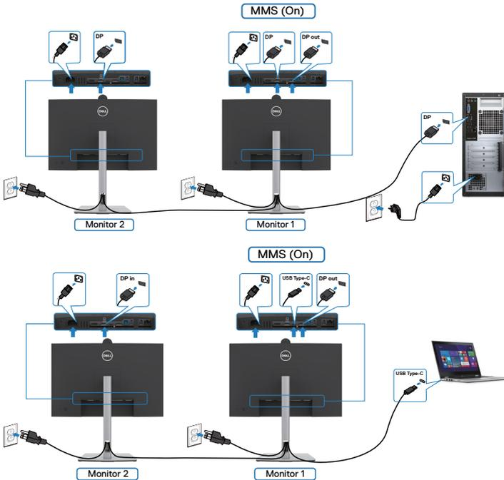
**NOTA:** Puede utilizar el dispositivo USB en el monitor 1 o en el monitor 2 solamente después de haber conectado el cable USB (C a A o B a A o C a C) entre el equipo y el monitor.
