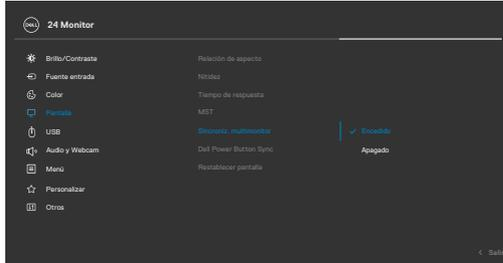
Si el Monitor 2 admite la Multi-Monitor Sync (sincronización de múltiples monitores), su opción MMS se establecerá automáticamente en **On (Activado)** para la sincronización.
