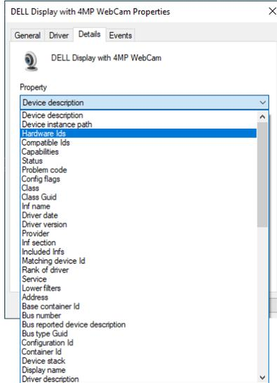
El campo **Value (Valor)** mostrará los detalles de los identificadores de hardware de esta **Pantalla DELL con cámara web de 4 MP**. Los identificadores de hardware de la cámara web integrada del portátil y de la cámara web del monitor son diferentes. Para el P2424HEB, los identificadores de hardware de la cámara web del monitor se mostrarán como a continuación:
