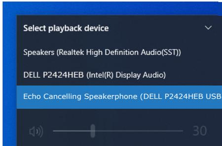
Si solo el cable HDMI o DP se conecta desde su monitor al equipo, solo un altavoz denominado **DELL P2424HEB** desde el monitor se mostrará en la configuración de la interfaz de configuración de **Sound (Sonido)**.
