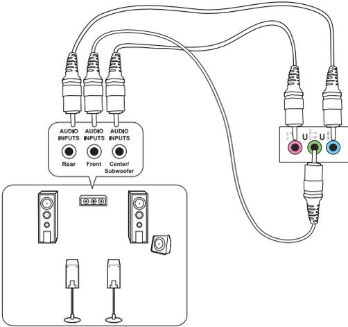
**Conexión de un sistema de altavoces de 7.1 canales**
