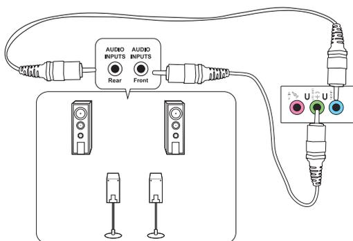
**Conexión de un sistema de altavoces de 5.1 canales**
