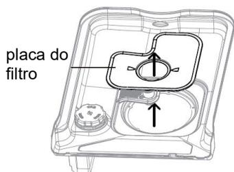
Com o filtro removido, levante cuidadosamente a placa do filtro para cima e para fora.
