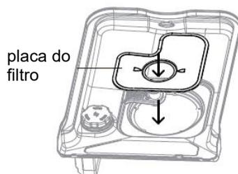
Insira a placa do filtro sob os cliques de localização na parte traseira do dreno e empurre firmemente para dentro do lugar. Certifique-se de que a placa do filtro está nivelada com a base da máquina de lavar louça.
