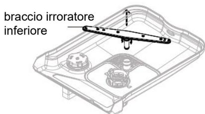
Per rimuovere il braccio irroratore inferiore, sollevarlo dalla base della lavastoviglie. Sciacquare accuratamente il braccio irroratore sotto l'acqua corrente, quindi rimontarlo. Assicurarsi che il braccio ruoti liberamente una volta rimontato.
