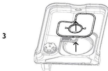
Rimuovere il filtro di scarico e la piastra del filtro. Utilizzare una spugna per rimuovere l'acqua che ristagna sotto prima di riposizionare la piastra.
