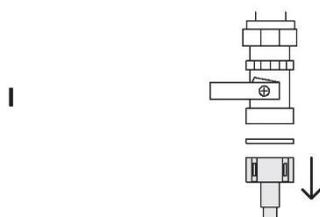
Chiusure l'alimentazione idrica. Scollegare i tubi di scarico dal tubo di scarico del lavandino e il tubo di carico dell'acqua dalla valvola dell'acqua.
