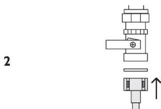
Scaricare l'acqua dai tubi flessibili, dal tubo di carico e dalla valvola dell'acqua, utilizzando un secchio o una bacinella per raccogliarla. Ricollegare il tubo di carico alla valvola dell'acqua e i tubi flessibili al tubo di scarico del lavandino.
