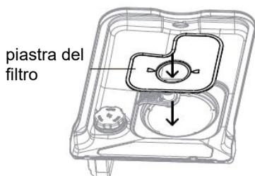
Inserire la piastra del filtro sotto le clip di posizionamento sul retro dello scarico e spingerla nuovamente in posizione. Assicurarsi che la piastra del filtro sia a filo con la base della lavastoviglie.
