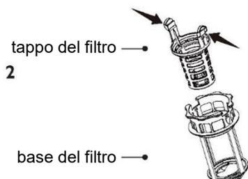
Separare il tappo dalla base del filtro premendo i pulsanti di sblocco e sollevandolo. Non tentare di rimuovere il filtro con la forza in quanto ciò potrebbe causare danni. Pulire sotto l'acqua calda e risciacquare abbondantemente.
