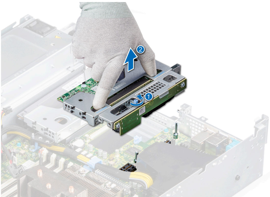
Abbildung 67. Entfernen des Riser 1A
