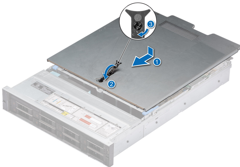
Figure 21. Installation du capot du système
