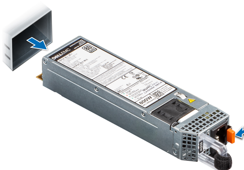
Figure 100. Retrait d'un bloc d'alimentation
