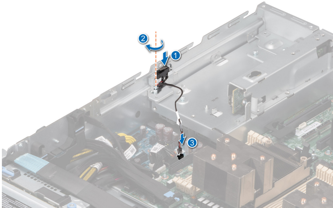
Ilustración 36. Instalación del interruptor de intrusiones
