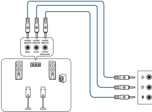
**Conexión de un sistema de altavoces de 7.1 canales**
