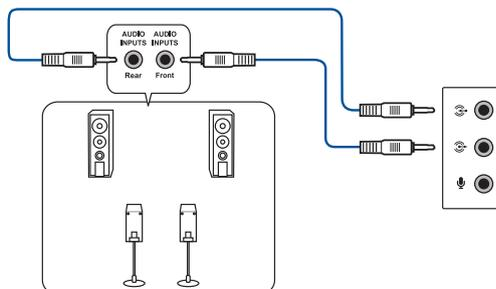
**Conexión de un sistema de altavoces de 5.1 canales**
