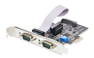
Ajoutez la prise en charge de la communication série à un ordinateur de bureau ou à un système de format Small Form Factor (SFF) grâce à cette carte PCI Express série à 2 ports. Les deux ports DB9 peuvent être configurés de manière indépendante pour prendre en charge les normes RS-232, RS-422 et RS-485 2/4 fils, pour la communication avec des périphériques série conformes.
