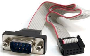
El Cable de Serie IDC a Serie para Panel de Montaje de 16 pulgadas, PNL9M16 ofrece una conexión al cabezal de placa base (IDC) de 10 pines en un extremo y un puerto conector DB9 macho para panel de montaje en el otro - una respuesta sencilla para agregar un puerto serie DB9 (RS232) a cualquier sistema informático que posea un receptáculo de montaje en panel para puerto serie RS232.
