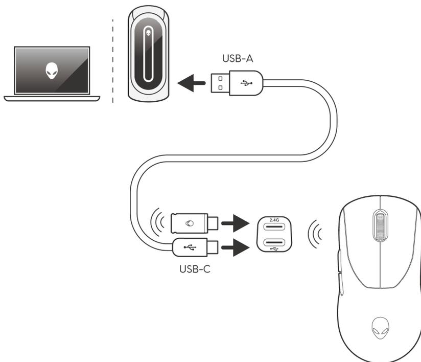
**NOTA:** si consiglia di utilizzare l'estensore del dongle per migliorare la stabilità della connessione wireless.
