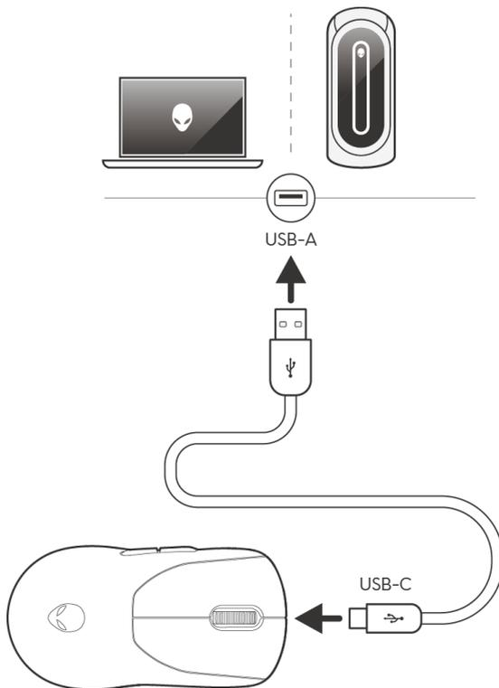
**NOTA:** la batteria inizia a caricarsi automaticamente in modalità cablata.
