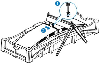
3. Bringen Sie die Verriegelung vorsichtig an der VESA-Halterung an, bis die VESA-Halterung an der Verriegelung einrastet.
