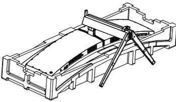
2. Lösen Sie die Montageschrauben, entfernen Sie dann den Holm vom Monitor.
