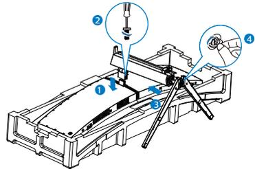
3. Richten Sie den Monitor nach Anbringung der Basis auf, indem Sie ihn mit beiden Händen sicher gemeinsam mit dem Styropor greifen. Nun können Sie das Styropor herausziehen. Drücken Sie den Bildschirm beim Herausziehen des Styropors nicht zusammen. Andernfalls könnte er beschädigt werden.
