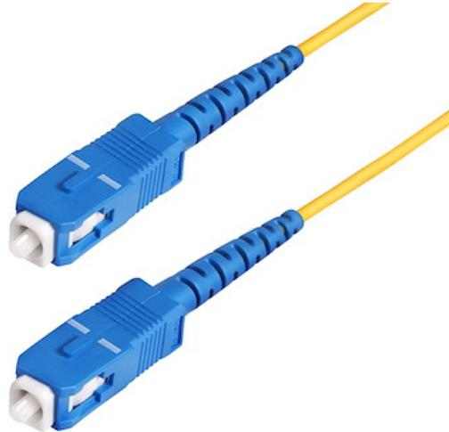
Le câble de raccordement fibre optique monomode simplex OS2 SC à SC facilite la connectivité sur les réseaux 40G/100G. Il prend en charge la multiplexage en longueur d'onde (CWDM) sur une plage de longueurs d'onde étendue de 1260 à 1625 nm, améliorant l'isolation des canaux pour une force de signal optimale sur de longues distances.
