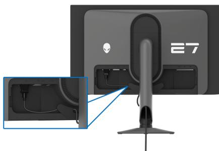
11. Collegare al monitor i cavi necessari, come il cavo DisplayPort-DisplayPort, USB-C-DisplayPort, HDMI, USB 3.2 Gen 1 (5 Gbps) upstream e downstream, e così via.
