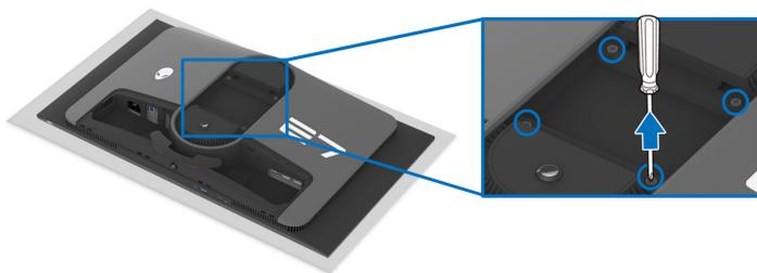
**NOTA:** Usare viti M4 x 10 mm per fissare il monitor al kit di montaggio a parete.
