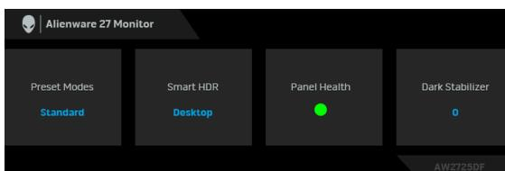
In genere, **Panel Health (Integrità pannello)** visualizza un punto verde. Quando è visualizzato un punto giallo, si consiglia di eseguire **Pixel Refresh (Aggiornamento pixel)**; quando è visualizzato un punto rosso, vuol dire che il monitor è stato utilizzato per 9000 ore senza eseguire **Panel Refresh (Aggiornamento pannello)**. Per ulteriori informazioni consultare **OLED Panel Maintenance (Manutenzione del pannello OLED)**.
