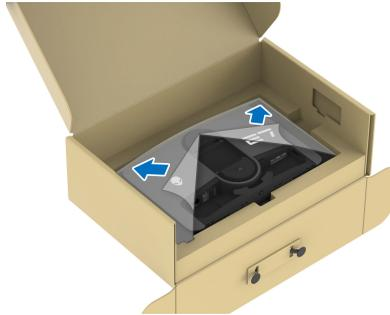
**NOTA:** Prima di fissare il gruppo di supporto al display, assicurarsi che il lembo della piastra frontale sia aperto per lasciare spazio per il montaggio.
