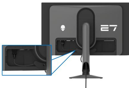
11. Connectez les câbles requis au moniteur, tels que le câble DisplayPort-DisplayPort, le câble USB-C-DisplayPort, le câble HDMI, les câbles USB 3.2 Gen 1 (5 Gbit/s) en amont et en aval, etc.
