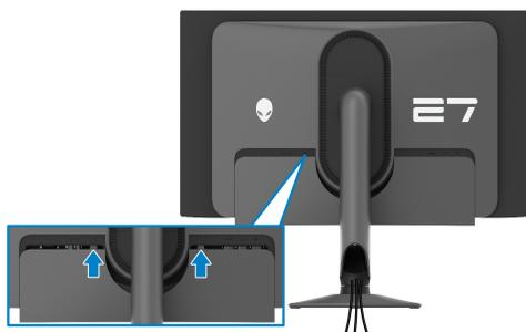
**REMARQUE :** Veillez à ce que tous les câbles passent à travers le couvercle E/S et l'orifice de rangement des câbles sur la colonne du pied.
