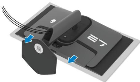
5. Déconnectez les câbles du moniteur et faites les sortir à travers l'orifice de rangement des câbles sur la colonne du pied.
