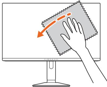
△ **AVERTISSEMENT** : Ne pas utiliser de détergents ou d'autres produits chimiques tels que le benzène, un diluant, de l'ammoniaque, des nettoyants abrasifs, d'alcool ou des produits à base d'air comprimé.
