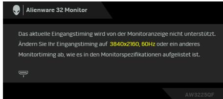
Das bedeutet, dass sich der Monitor nicht richtig auf das Signal einstellen kann, das er vom Computer empfängt. In den [Technische Daten des Monitors](#) finden Sie die von Ihrem Monitor unterstützten Horizontal- und Vertikalfrequenzen. Die empfohlene Auflösung ist **3840 x 2160**.
