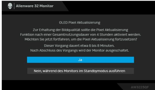
Wenn Sie **Ja** wählen, wird der Monitor ausgeschaltet und der Aktualisierungsvorgang automatisch ausgeführt. Der Vorgang dauert ca. 6 bis 8 Minuten bis zum Abschluss.
