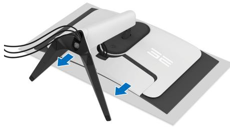
5. Trennen Sie die Kabel vom Monitor und schieben Sie sie durch die Kabelführungsöffnung am Ständer.
