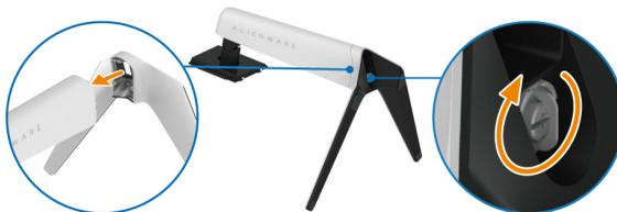
5. Öffnen Sie die Schutzabdeckung am Monitor, um auf den VESA Steckplatz an der Rückseite des Monitors zuzugreifen.
