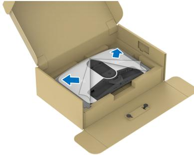
6. Fügen Sie die Laschen am Ständer vorsichtig in die Schlitzte an der hinteren Abdeckung des Monitors ein und drücken Sie den Ständer nach unten, um ihn einrasten zu lassen.
