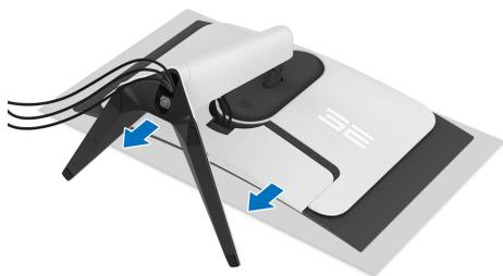
5. Déconnectez les câbles du moniteur et faites les sortir à travers l'orifice de rangement des câbles sur la colonne du pied.
