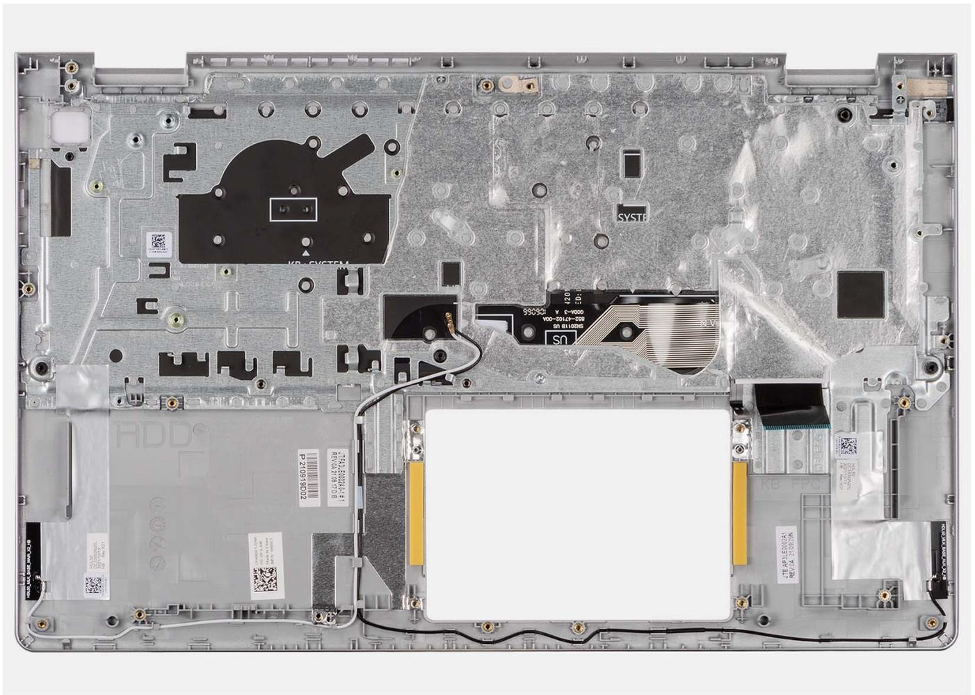
**i** **NOTA:** Para sistemas con un chasis de aluminio, los soportes metálicos de RF izquierdo y derecho se deben transferir al reposamanos de reemplazo.
