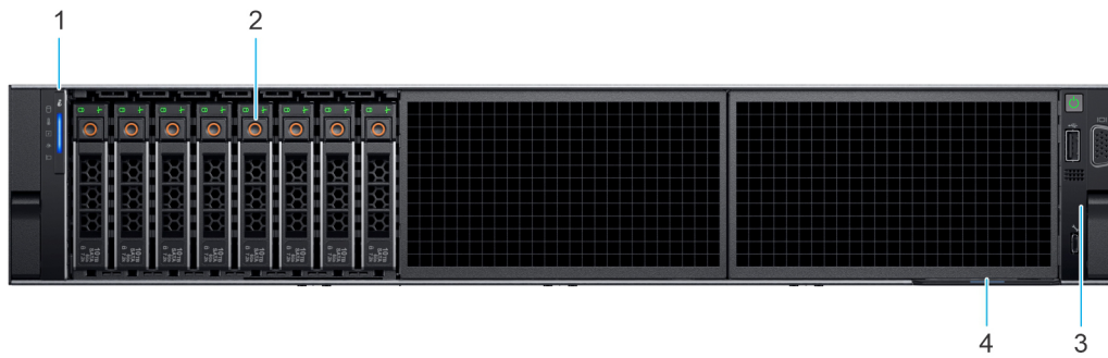
Ilustración 4. Vista frontal de un sistema de 8 unidades SAS/SATA de 2,5 pulgadas
