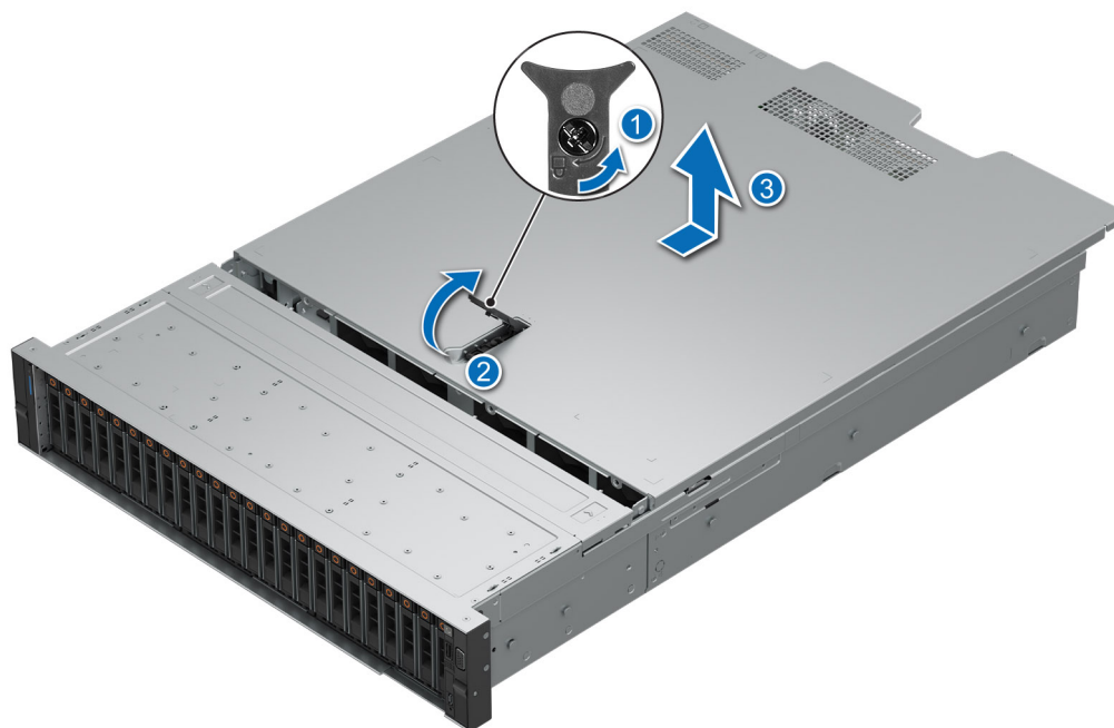
Ilustración 30. Extracción de la cubierta del sistema
