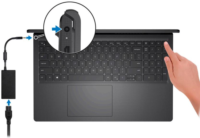
**i | POZNÁMKA:** Kvůli úspoře energie může baterie přejít do úsporného režimu. Připojte napájecí adaptér a stisknutím tlačítka napájení počítač zapněte.
