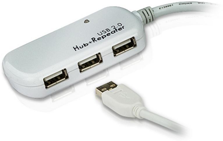
Le concentrateur UE2120H est un concentrateur d'extension actif qui permet d'augmenter la distance qui sépare un ordinateur d'un ou plusieurs périphériques USB jusqu'à 12 mètres. Les signaux USB transmis par le biais de ces câbles conservent une intégrité optimale et sont conformes aux standards USB 2.0. Il est possible de connecter en chaîne jusqu'à 4 câbles d'extension ([UE2120](#)) et 1 concentrateur d'extension (UE2120H), de sorte que la distance peut être étendue jusqu'à 60 mètres.
