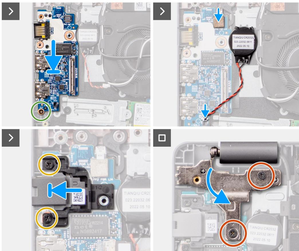
**ATTENZIONE:** Il sistema ha una batteria a bottone collegata alla scheda di I/O. La disconnessione del cavo della scheda di I/O comporta il ripristino del programma di configurazione del BIOS alle impostazioni predefinite. Prendere nota delle impostazioni del programma di configurazione del BIOS prima di scollegare il cavo della scheda di I/O.
