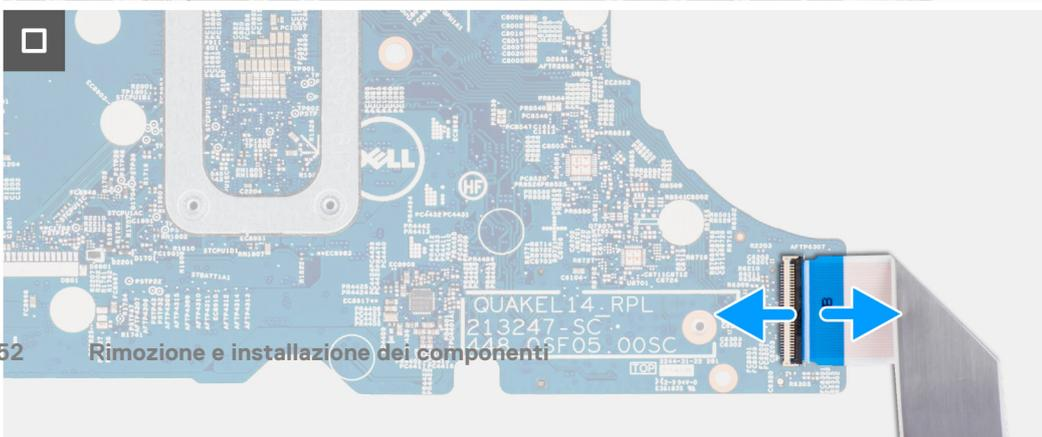
**ATTENZIONE:** Il sistema ha una batteria a bottone collegata alla scheda di I/O. La disconnessione del cavo della scheda di I/O comporta il ripristino del programma di configurazione del BIOS alle impostazioni predefinite. Prendere nota delle impostazioni del programma di configurazione del BIOS prima di scollegare il cavo della scheda di I/O.
