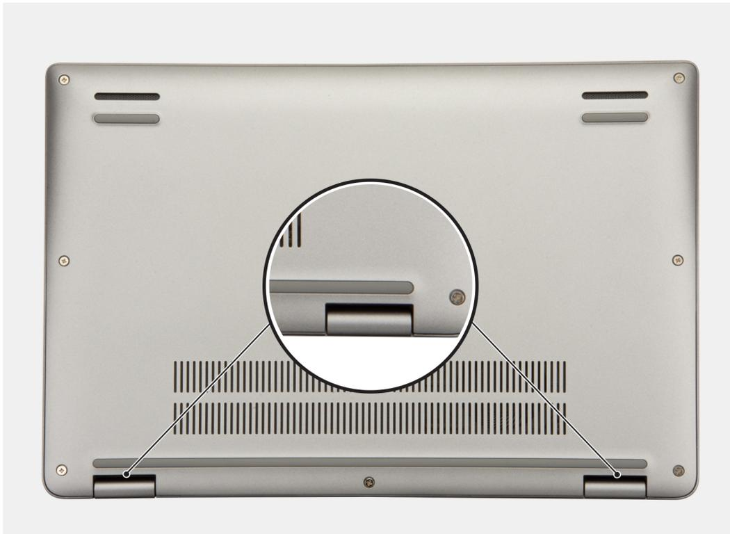
3. Fare leva sul lato superiore del coperchio della base e continuare a lavorare sui lati sinistro, destro e inferiore per aprirlo.
