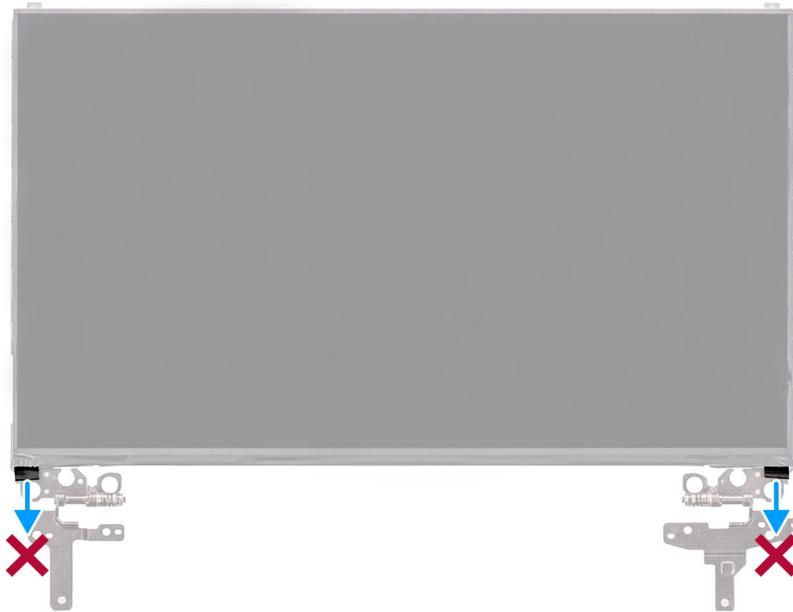
1. Rimuovere le sei viti (M2.5x2.5) che fissano la cerniera destra e sinistra al coperchio posteriore del display.
