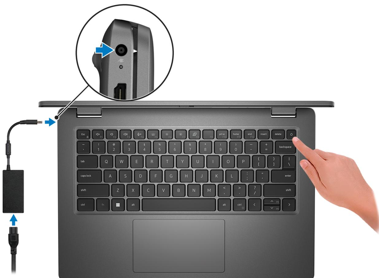
**i** **N.B.:** Per conservare autonomia, la batteria potrebbe entrare in modalità di risparmio di energia. Collegare l'adattatore per l'alimentazione e premere il pulsante di accensione per accendere il computer.
