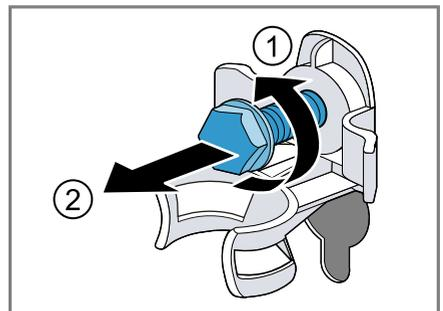
3. Die Netzanschlussleitung von der Halterung entfernen.
