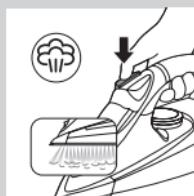
La función supervapor de la suela especial con punta activa ayuda a eliminar las arrugas más rebeldes. El supervapor mejora la distribución del vapor en todas las zonas de la prenda. La función de Supervapor sólo se puede usar a temperaturas de planchado entre ●●● y MAX.
