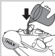
**4** Ütüyü geriye doğru eğin ve doldurma kabını kullanarak su haznesini maksimum seviyeye kadar musluk suyu ile doldurun.
