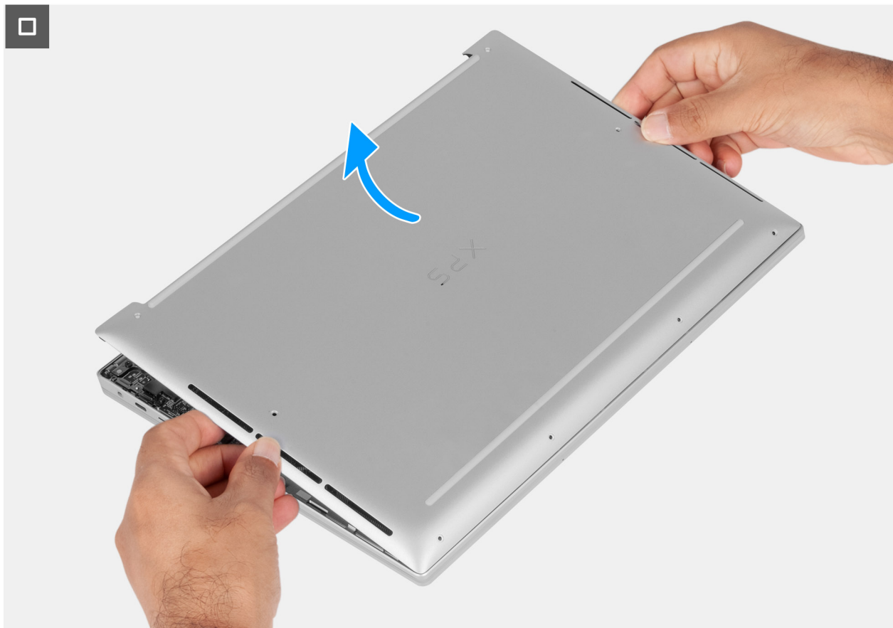
איור 15. הסרת כיסוי הבסיס
