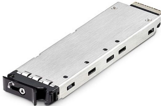
Un plateau de disque de rechange pour M2-REMOVABLE-PCIE-N1 ou 2M2-REMOVABLE-PCIE, permettant d'ajouter ou de remplacer un disque compatible. Le plateau de disque peut accueillir des SSD NVMe M-Key M.2 de tailles 2230, 2242, 2260 et 2280.
