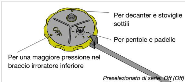
Lasciare aperte le power zone per un maggiore flusso d'acqua nelle posizioni in cui sono state collocate, ad esempio, pentole e padelle o decanter e stoviglie sottili. Chiudere le power zone della lavastoviglie per ottenere una maggiore pressione di irrorazione nel braccio irroratore inferiore.
