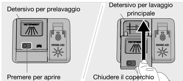
Quando si aggiunge detersivo, lo scomparto del detersivo deve essere asciutto. È presente uno scomparto per il prelavaggio e uno per il lavaggio principale. Se si utilizza detersivo in polvere per lavastoviglie o detersivo in gel per lavastoviglie, è possibile aggiungere una piccola quantità di detersivo nello scomparto per il prelavaggio. Contattare il produttore del detersivo in caso di domande in merito.
