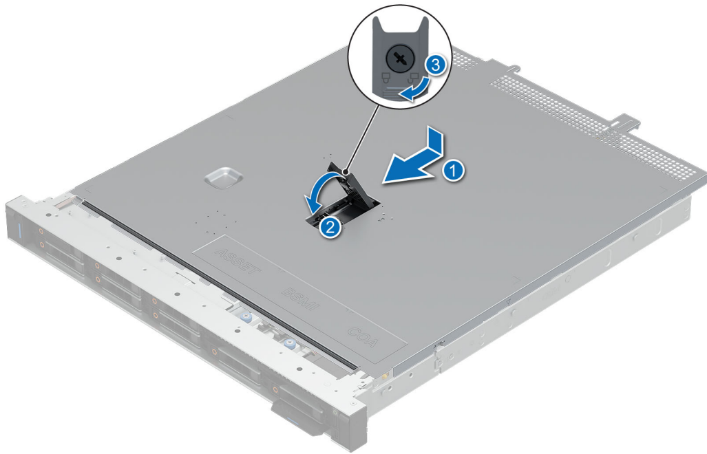
Ilustración 17. Instalación de la cubierta del sistema
