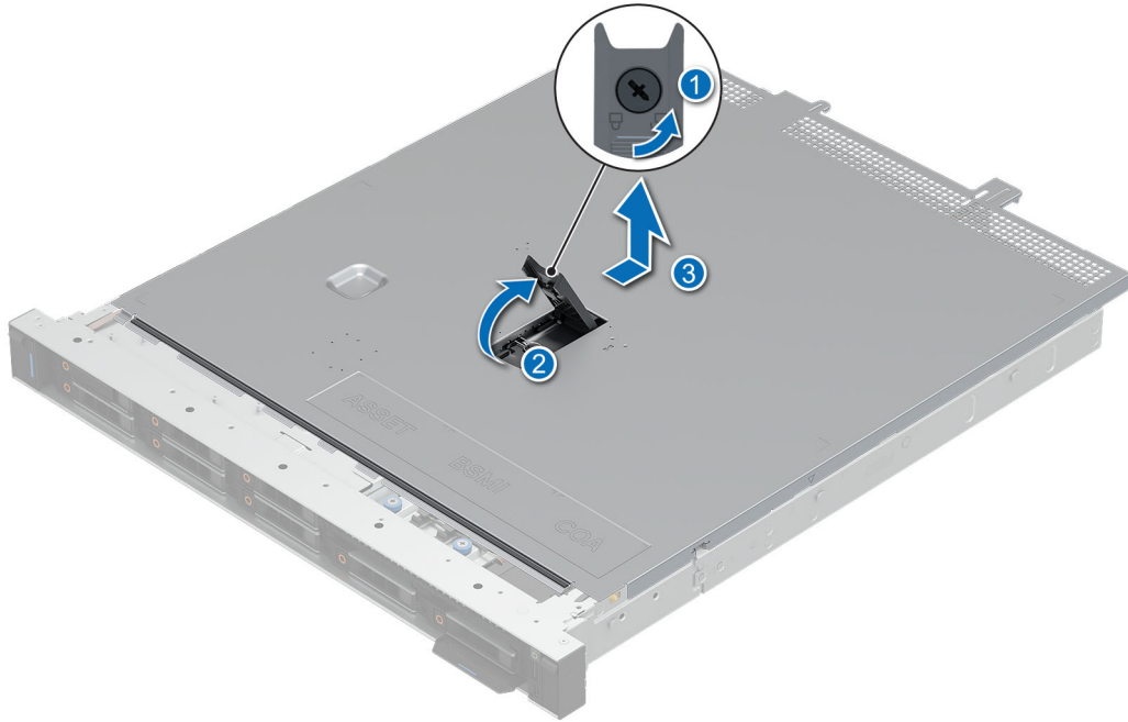
Ilustración 16. Extracción de la cubierta del sistema
