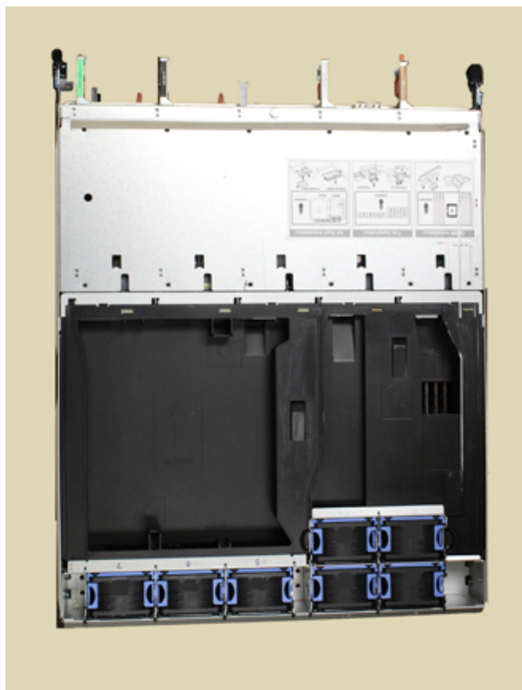
Figura 7 Exibição superior do módulo da controladora do sistema
