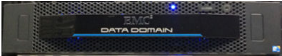
Figura 3 Painel exibindo o LED de alimentação do sistema aceso
