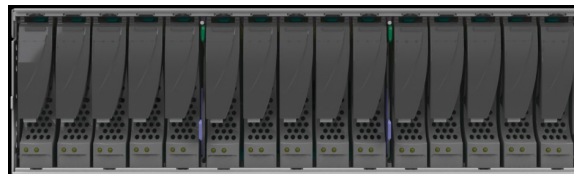
Figura 119 Painel frontal da FS15 (painel removido)
