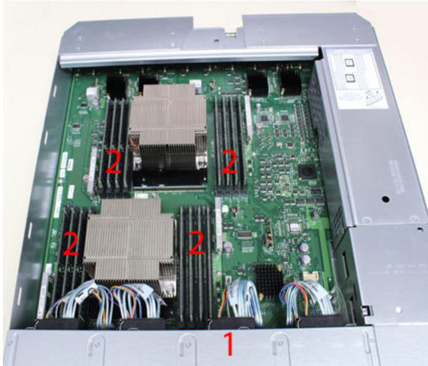
Figura 27. Exibição superior do módulo da SP com tampa da SP removida
