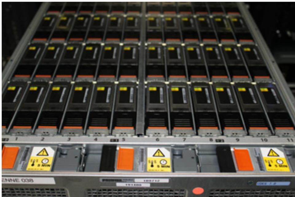
**Figura 173. Ventiladores e unidades de disco do compartimento de disco**
