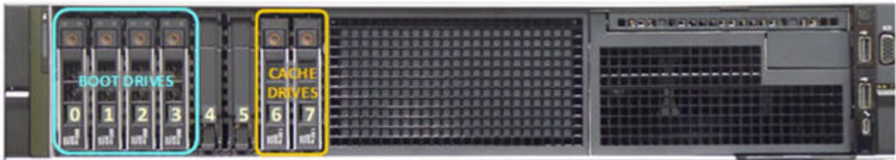
Figura 89. DD6900 Atribuição de slot de SSD
