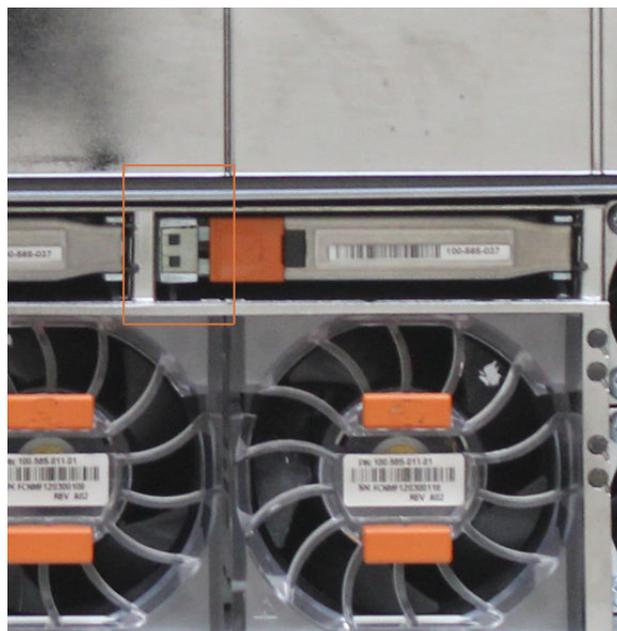
Figura 53. LEDs de SSD e ventiladores
