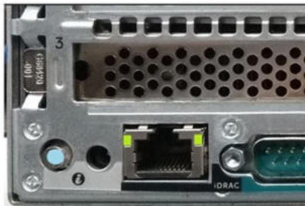
Figura 91. LEDs de iDRAC e ID integrados
