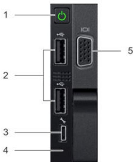
Figura 166. LEDs do botão liga/desliga do painel de controle do lado frontal direito
