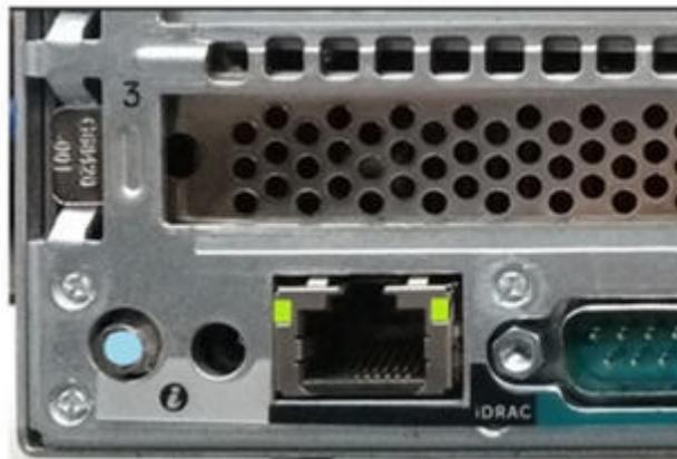
Figura 129. LEDs de iDRAC e ID integrados
