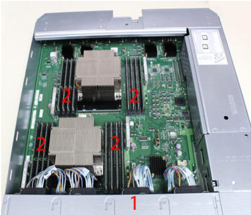
**Figura 56. Exibição superior do módulo da SP com tampa da SP removida**
