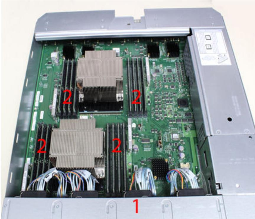
Figura 100. Exibição superior do módulo da SP com tampa da SP removida
