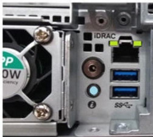
Figura 169. LEDs de iDRAC e ID integrados
