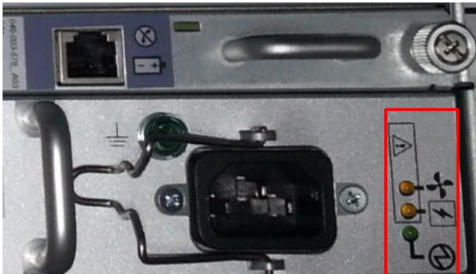
Figura 179. LEDs da fonte de alimentação A
