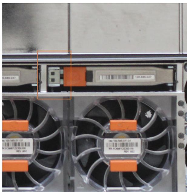
Figura 97. LEDs de SSD e ventiladores
