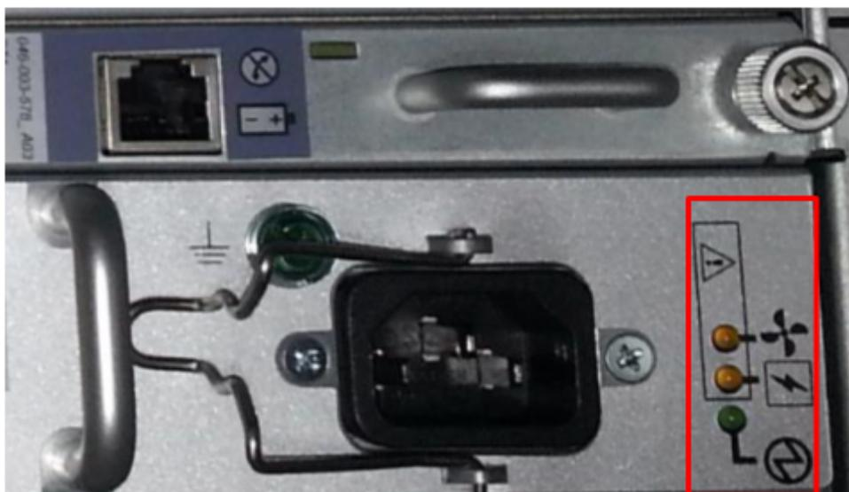
**Figura 183. LEDs da fonte de alimentação A**
