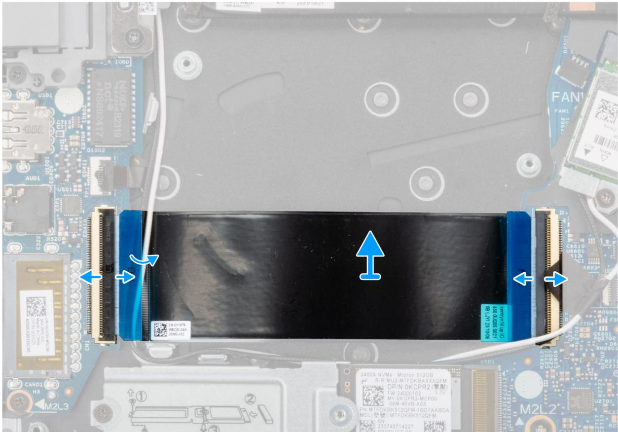
Figura 34. Rimozione del cavo della scheda di I/O
