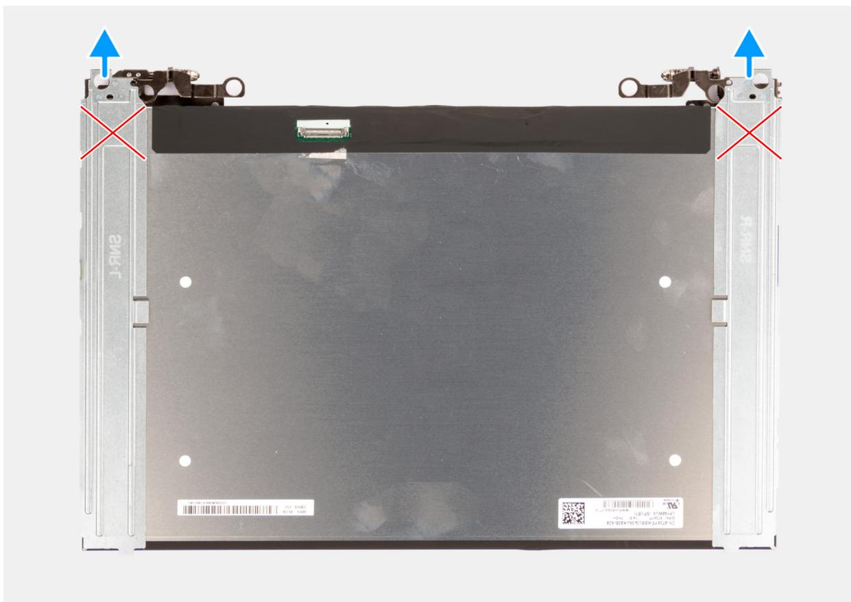
Figura 57. Rimozione del pannello del display
