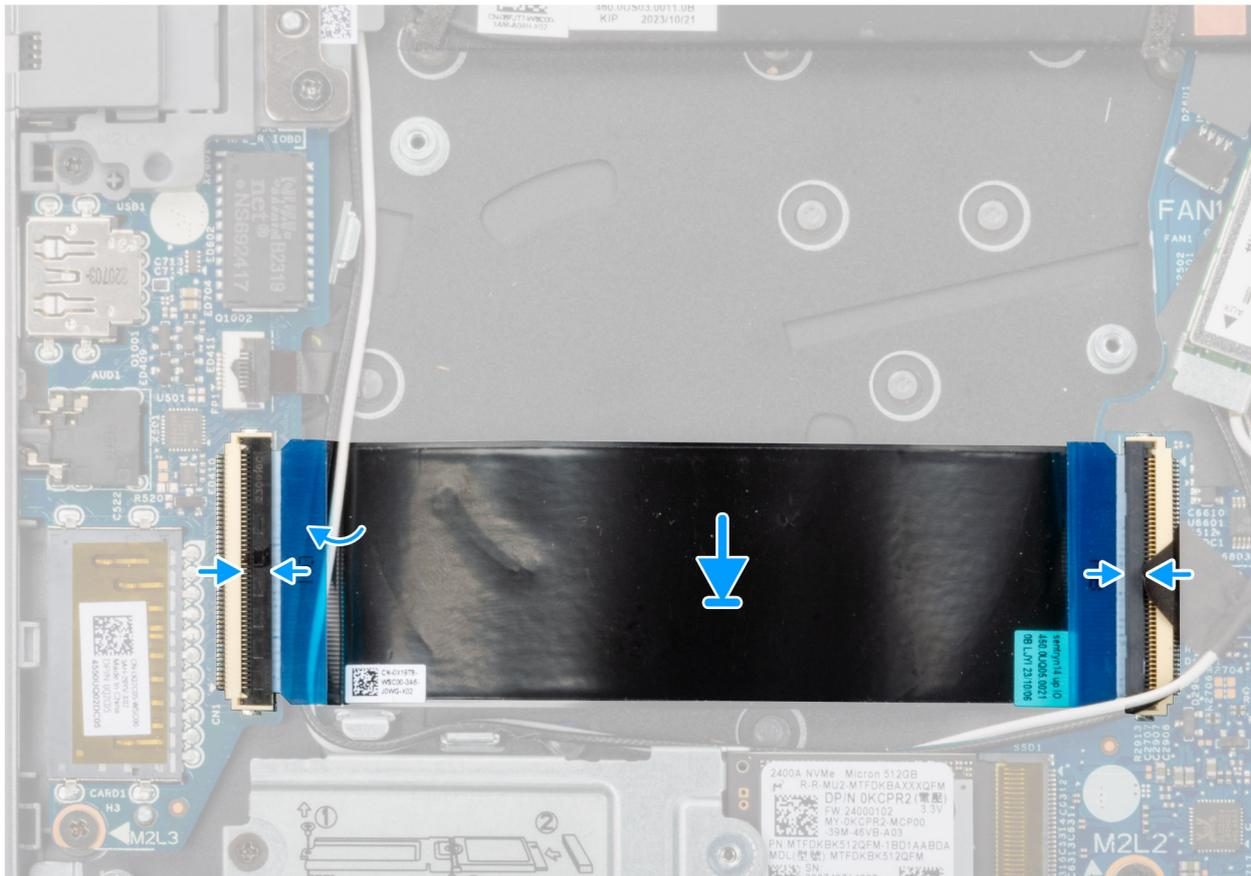
**Figura 35. Installazione del cavo della scheda di I/O**
