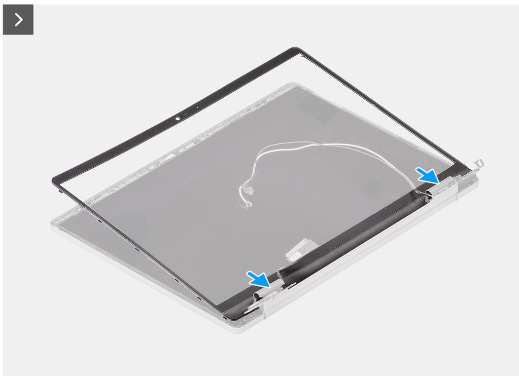
**Figura 51. Installazione della cornice del display**
