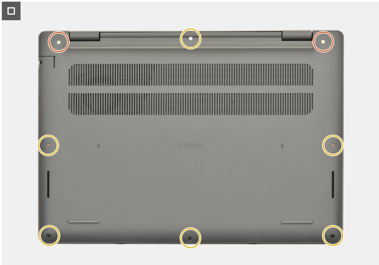
**Figura 13. Installazione del coperchio della base**
