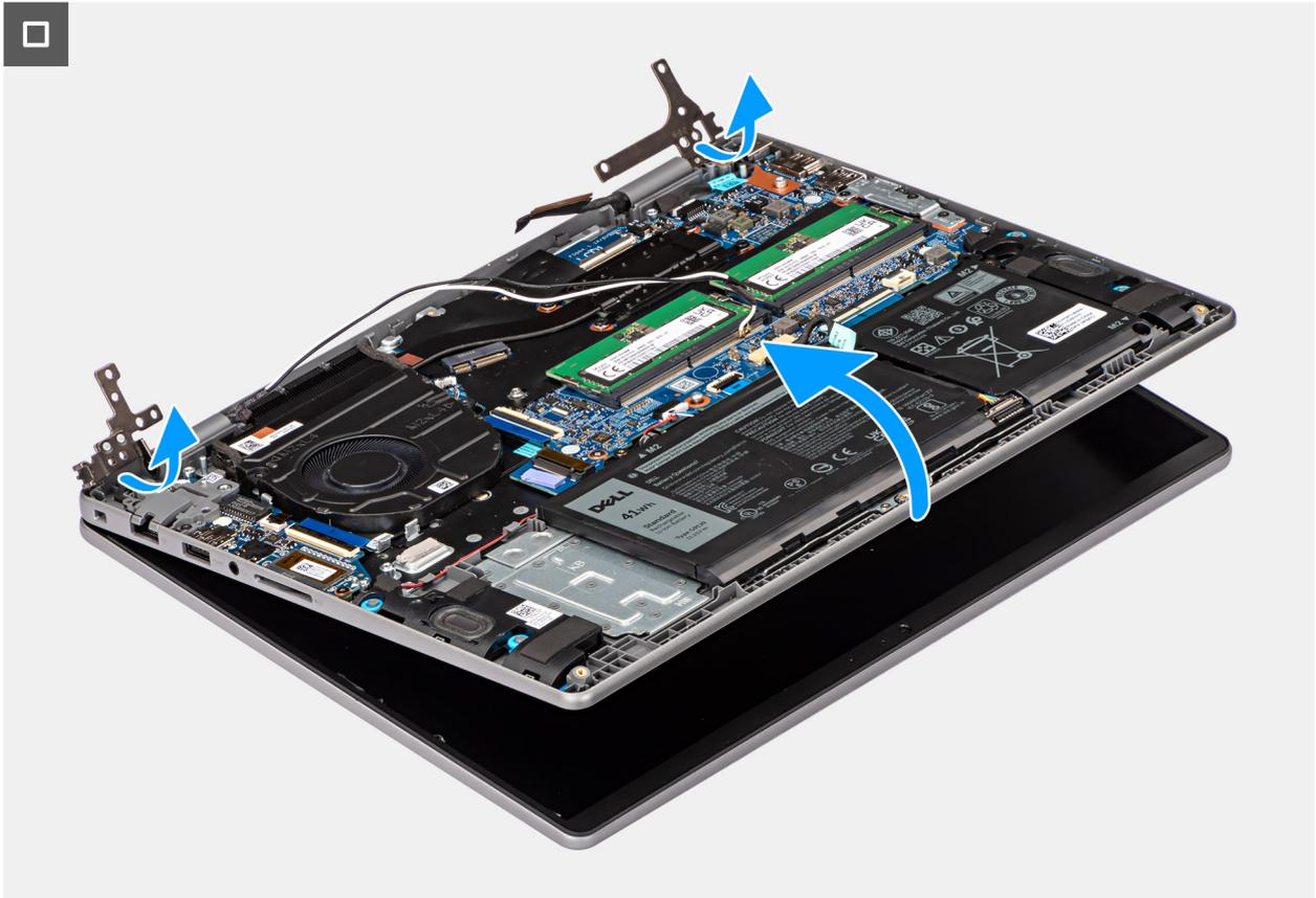
Figura 43. Rimozione del gruppo del display
