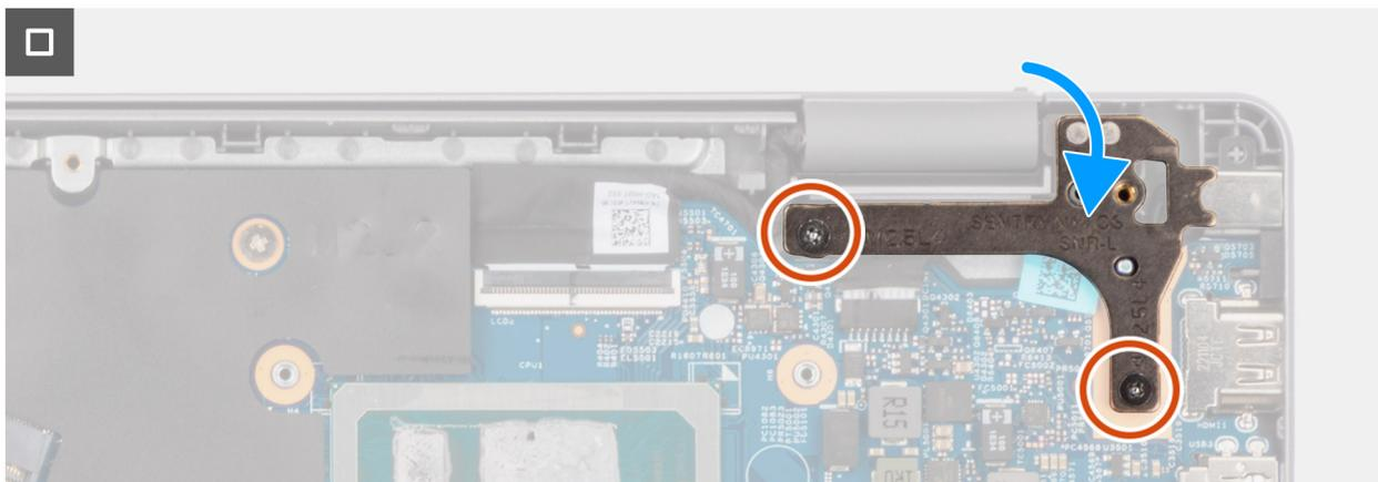
**Figura 76. Installazione della scheda di sistema**
