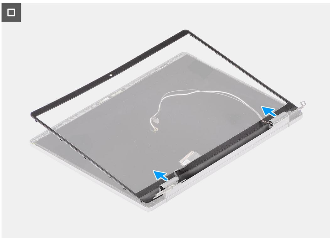
Figura 49. Rimozione della cornice del display
