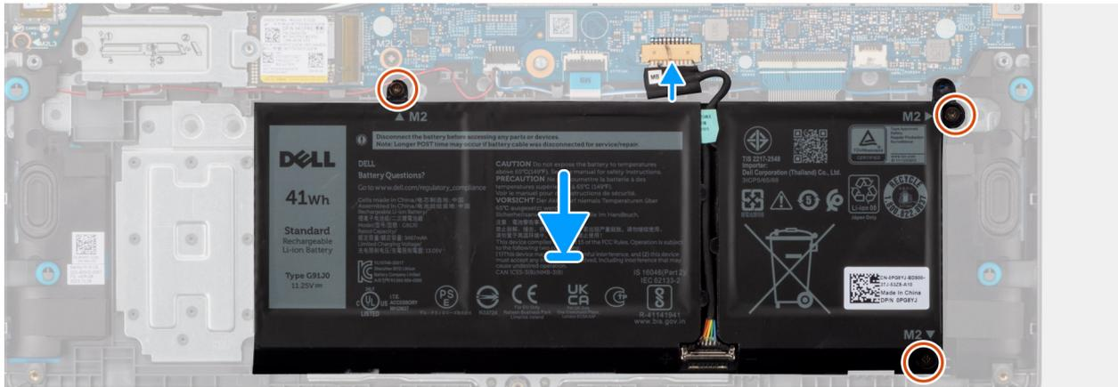
Figura 23. Installazione della batteria
