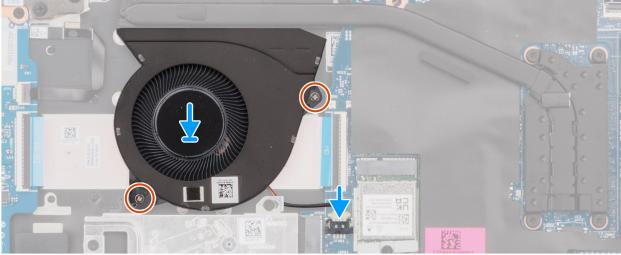
Figure 27. Installing the fan
