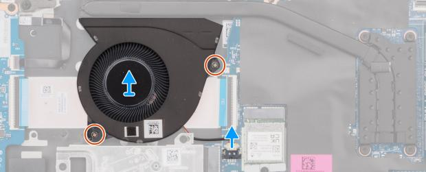
Figure 26. Removing the fan
