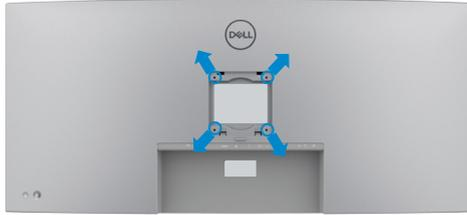
**NOTA: Utilizzare viti M4 x 10 mm per collegare il monitor al kit di installazione a parete.**
