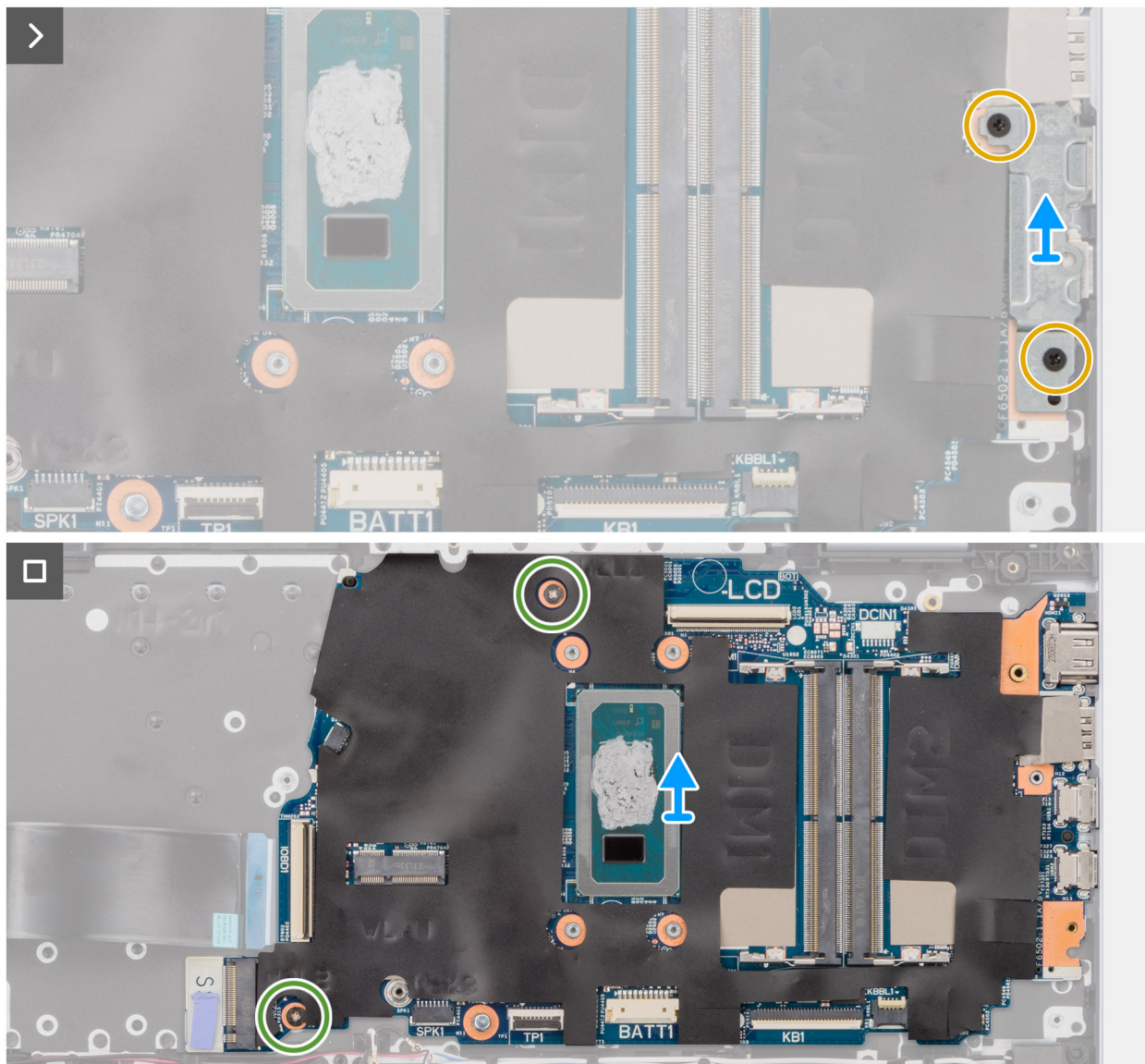
Rysunek 48. Wymontowywanie klamry portu USB-C i płyty głównej
