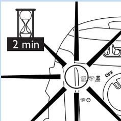
Bu cihaz Otomatik Kireç Temizleme fonksiyonuyla donatılmıştır. Buhar üreticinin içinde zamanla kireç parçacıkları oluşur. 6-8 hazne su kullanıldıktan sonra cihaz, kireci temizlemek için otomatik olarak bir Kireç Temizleme işlemi başlatır.
