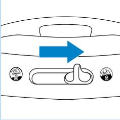
**4** Schieben Sie den Hebel für die Transportverriegelung nach rechts, um das Bügeleisen auf der Dampfheute zu fixieren.
