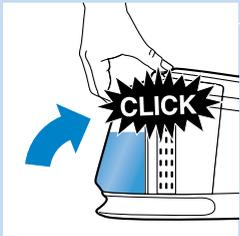
**4** Füllen Sie den Wasserbehälter erneut auf, und setzen Sie ihn wieder auf die Dampfeinheit.
