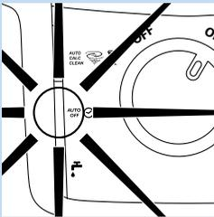
*Obs! Om du inte använder strykjärnet under längre än 10 minuter stängs apparaten av automatiskt av säkerhetsskäl. Lampan för automatisk avstängning blinkar. Slå på apparaten igen genom att trycka på vilken knapp som helst.*
