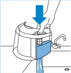
**4** Riempite il serbatoio dell'acqua e collegatelo nuovamente al generatore di vapore.
