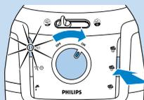
**3** Per avviare il processo Calc Clean manualmente, tenete premuto il pulsante centrale di scelta del vapore mentre accendete il ferro. Rilasciatelo solo quando la spia della funzione automatica Calc Clean lampeggia.
