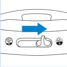
**4** Deslice el botón de bloqueo hacia la derecha para fijar la plancha al generador de vapor.
