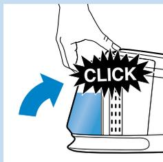
**4** Remplissez à nouveau le réservoir d'eau et replacez-le sur la chaudière.
