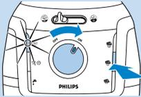
**3** Om het Calc-Clean-proces handmatig te starten, houdt u de middelste stoomstandkeuzeknop ingedrukt terwijl u het apparaat inschakelt. Laat de knop voor de stoomstand pas los als het blauwe lampje van de automatische Calc-Clean-functie knippert.
