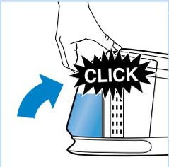
**4** Ξαναγεμίστε τη δεξαμενή νερού και επανατοποθετήστε τη στη γεννήτρια ατμού.
