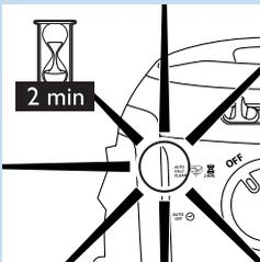
Apparaten är utrustad med en funktion för automatisk avkalkning. Med tiden bildas kalkpartiklar på insidan av ånggeneratoren. Apparaten utför en automatisk avkalkning för att ta bort kalkavlagringarna efter att mellan sex och åtta behållare vatten har använts.
