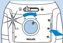
*Merk: Den manuelle kalkrensprosessen kan kun aktiveres om apparatet er kaldt nok. Hvis apparatet er for varmt for den manuelle kalkrensprosessen, blinker lampen for dampvelger og apparatet fortsetter å varme seg opp for bruk.*
