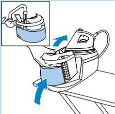
**2** Füllen Sie den Wasserbehälter bis zur Markierung MAX.
