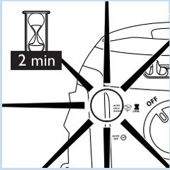
**1** Während des automatischen Calc-Clean-Vorgangs blinkt die Anzeige “Auto Calc Clean”, und Sie hören kurze Tonsignale.
