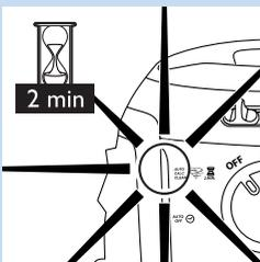
Tässä laitteessa on automaattinen kalkinpoistotoiminto. Ajan mittaan höyrylaitteeseen kertyy kalkkihiukkasia. Laite puhdistaa itsensä automaattisesti kalkinpoistotoiminnolla, kun on käytetty 6–8 säiliöllistä vettä.
