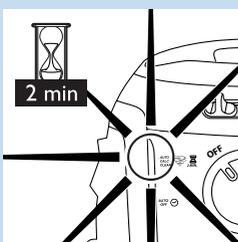
Dette apparatet er utstyrt med en automatisk kalkrensfunksjon. Over tid samler det seg opp kalkpartikler i dampgeneratoren. Apparatet utfører automatisk en kalkrensprosess for å fjerne kalkrester etter du har fylt og tømt vannbeholderen seks til åtte ganger.
