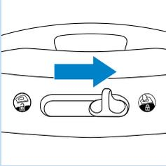
**4** Deslize o botão de fixação para a direita de modo a fixar o ferro ao vaporizador.
