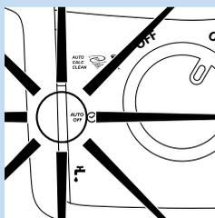
*Σημείωση: Εάν δεν χρησιμοποιήσετε το σίδερο για περισσότερο από 10 λεπτά, η συσκευή θα απενεργοποιηθεί αυτόματα για λόγους ασφαλείας. Η λυχνία αυτόματης απενεργοποίησης αναβοσβήνει. Για να ενεργοποιήσετε ξανά τη συσκευή, πιέστε οποιοδήποτε κουμπί.*
