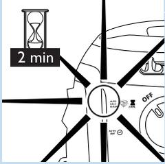
**1** Cuando el proceso automático Calc Clean se lleva a cabo, el piloto de función automática Calc Clean parpadea y se oyen breves pitidos.
