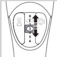
3 设置合适的蒸汽设定（见“使用准备”一章中的“选择温度和蒸汽设定”一节）。
