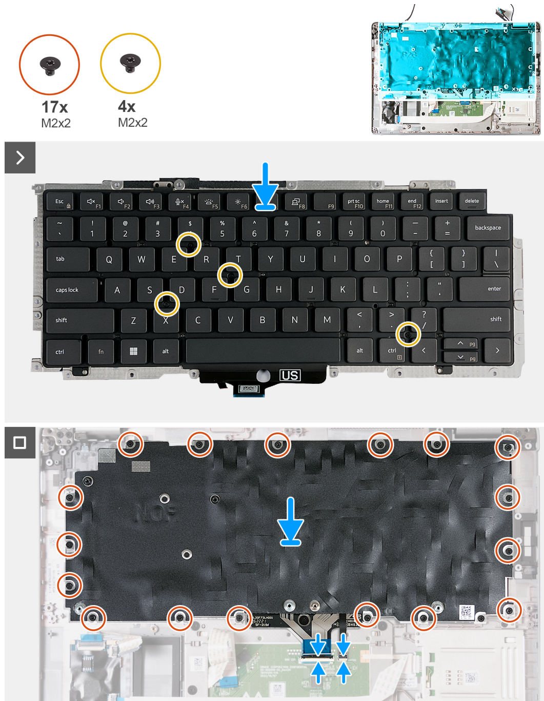
Abbildung 81. Einbauen der Tastatur
