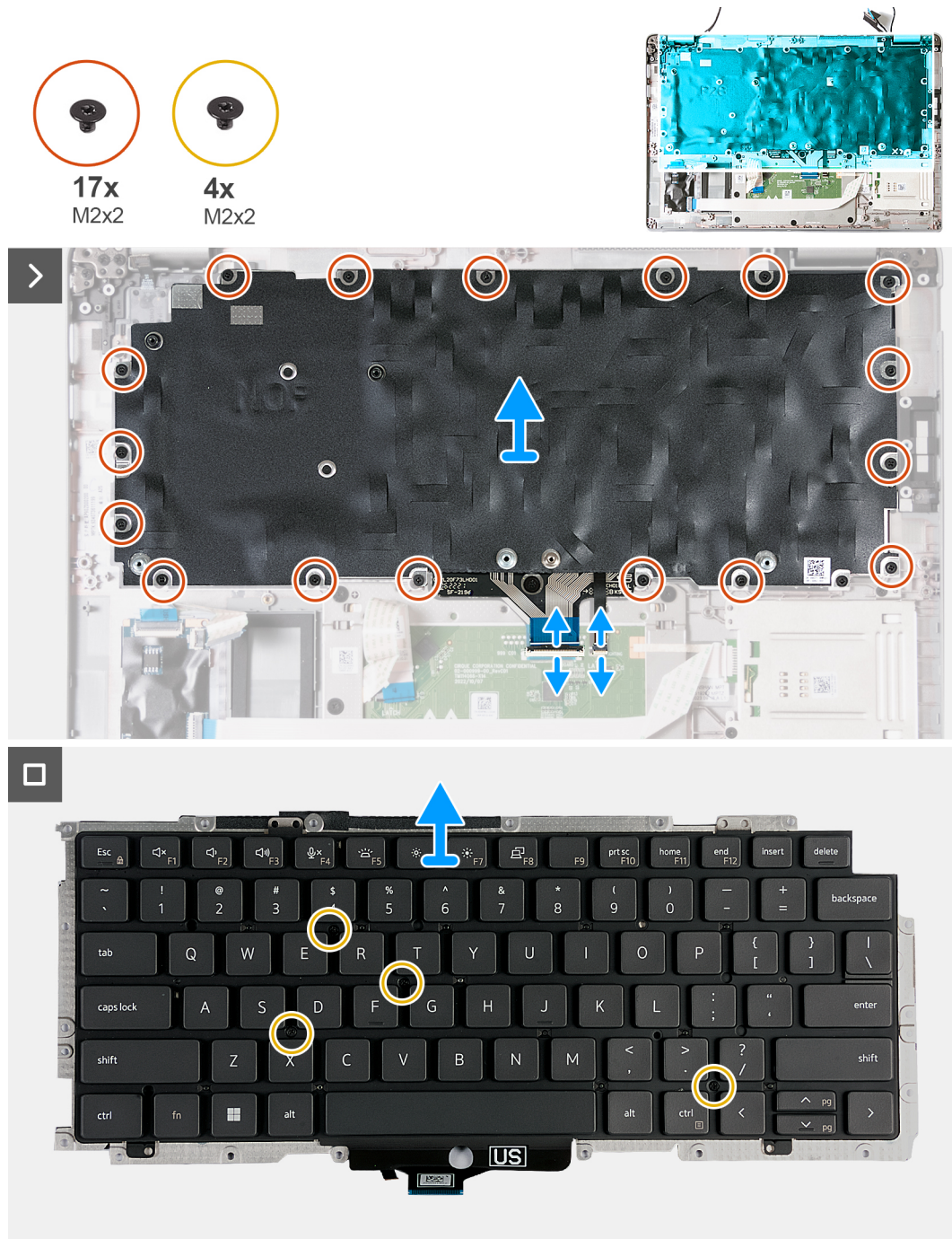
Abbildung 79. Entfernen der Tastatur
