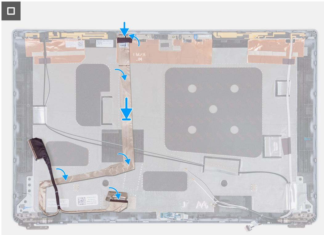
Figure 91. Installation du câble de l'écran
