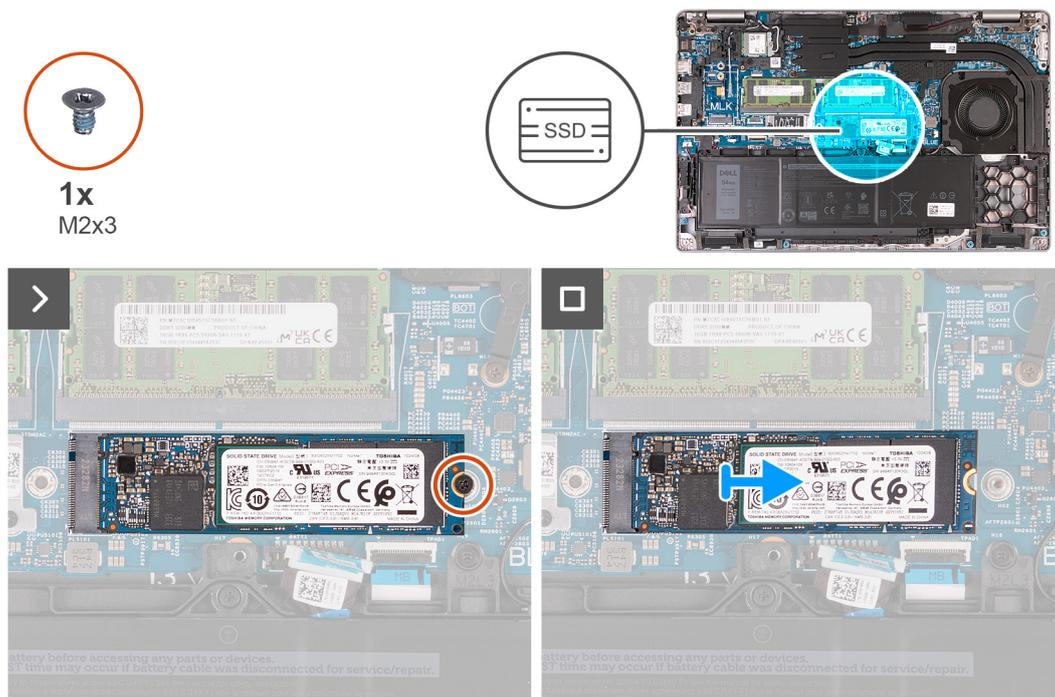
**Figure 29. Retrait du disque SSD M.2 2280 du logement 1**
