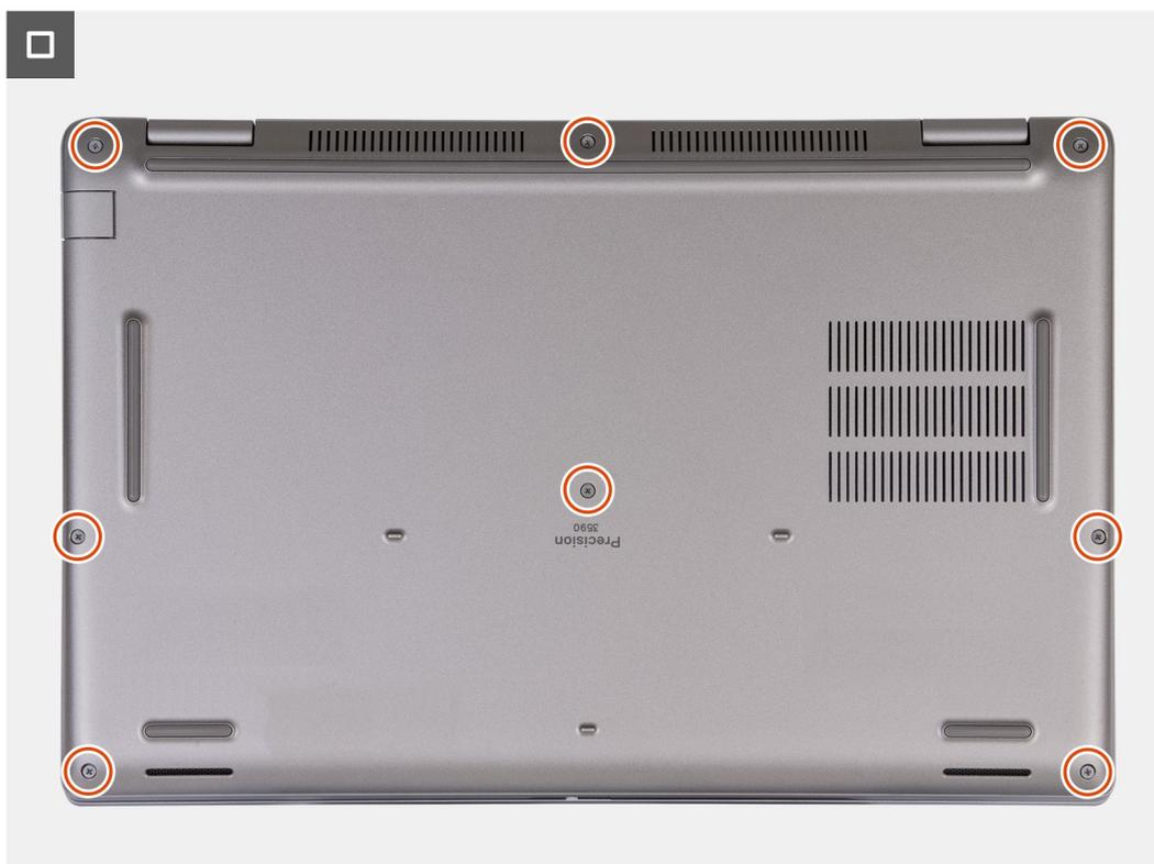
Figure 18. Serrage des vis imperdables
