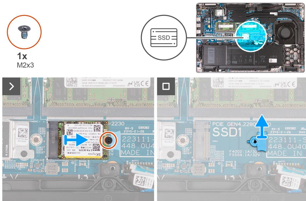
Figure 27. Retrait du disque SSD M.2 2230 du logement 1
