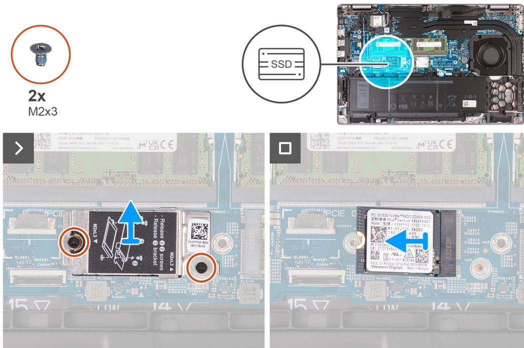
Figure 31. Retrait du disque SSD M.2 2230 du logement 2
