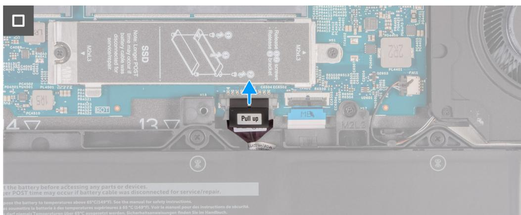
Figure 15. Déconnexion du câble de la batterie
