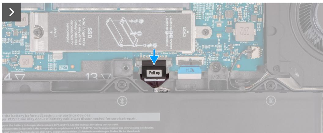
Figure 16. Connexion du câble de la batterie
