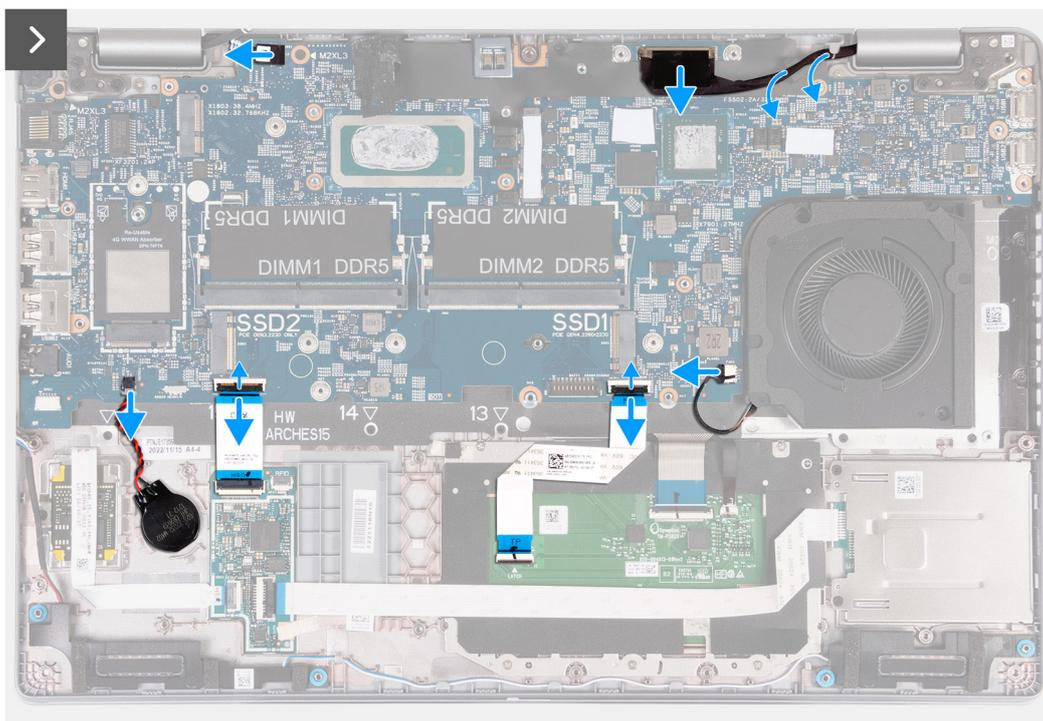
Figure 54. Déconnexion des câbles de la carte système
