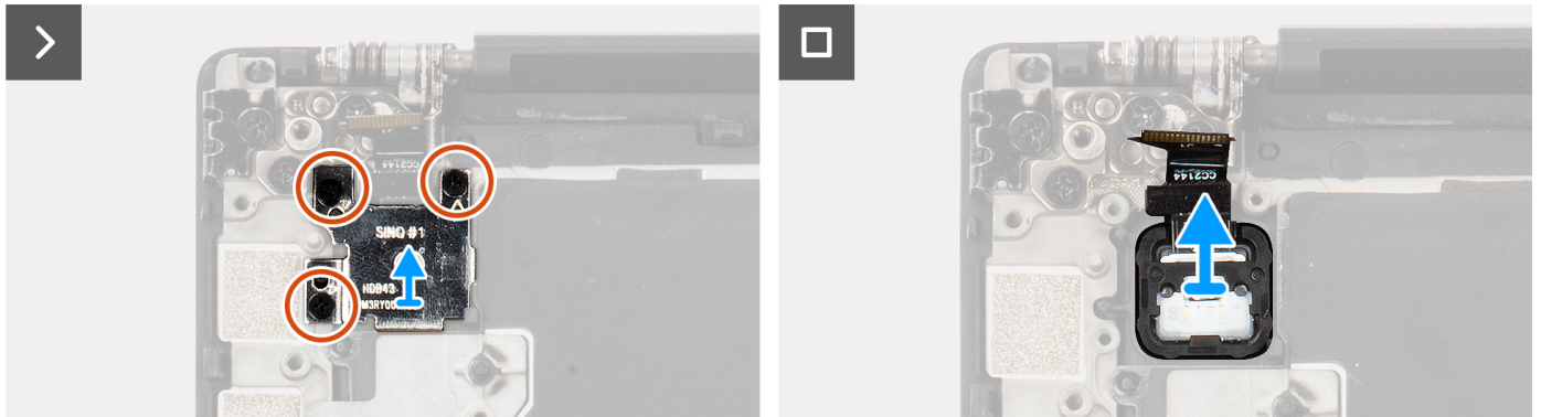
Figure 69. Retrait de la carte du bouton d'alimentation avec lecteur d'empreintes digitales
