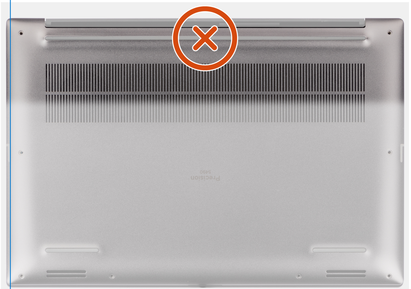
Figure 31. Ne faites pas levier depuis la partie supérieure du cache de fond
