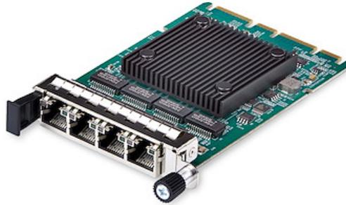
Cette carte réseau à quatre ports RJ45 de 1 Gbit/s, conforme à la norme OCP 3.0, est dotée d'un contrôleur Ethernet Intel® i350-AM4, améliorant ainsi les performances et l'intégrité des données. La carte Ethernet est conforme aux normes OCP 3.0 et garantit une large compatibilité, en en faisant une solution idéale pour une connectivité réseau fiable et des capacités de transfert de données robustes.
