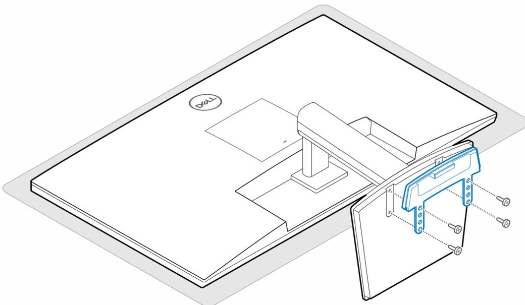
4. Instale los dos tornillos (M3x6) para asegurar la funda del adaptador de CA (venta adicional) a la placa del alargador.
