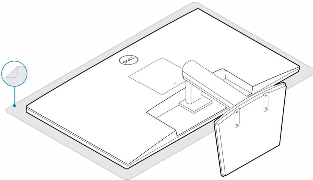
3. Instale los cuatro tornillos (M2.5x7) para fijar el alargador a la base de monitor.
